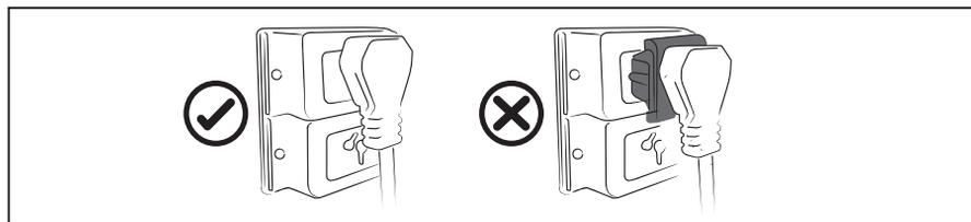
**⚠ Atención:** Para mantener intacta la protección contra descargas eléctricas (aparate CLASE I IRAM 2092): **NO USAR ADAPTADORES QUE ELIMINEN LA CONEXIÓN A TIERRA.**
