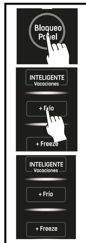
**Importante:** Esta función se desactivará de forma automática luego de 50 horas. El aparato seguirá funcionando a la temperatura ajustada con anterioridad.
