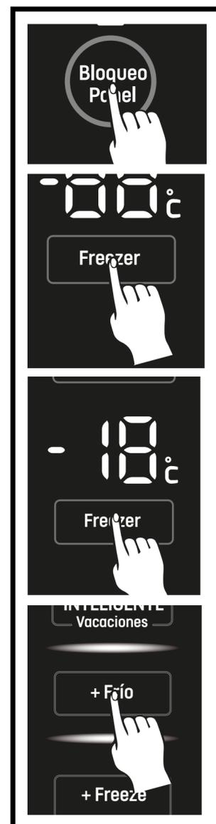
**IMPORTANTE:** La temperatura no puede ser ajustada, si cualquier otra función (+ Frío, + Freeze, vacaciones o inteligente) se activa o la pantalla está bloqueada. El indicador correspondiente parpadeará acompañado con un timbre.
