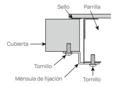
Asegure el anafe vitrocerámico contra la parte inferior de la cubierta de cocina utilizando los elementos de fijación incluídos.
